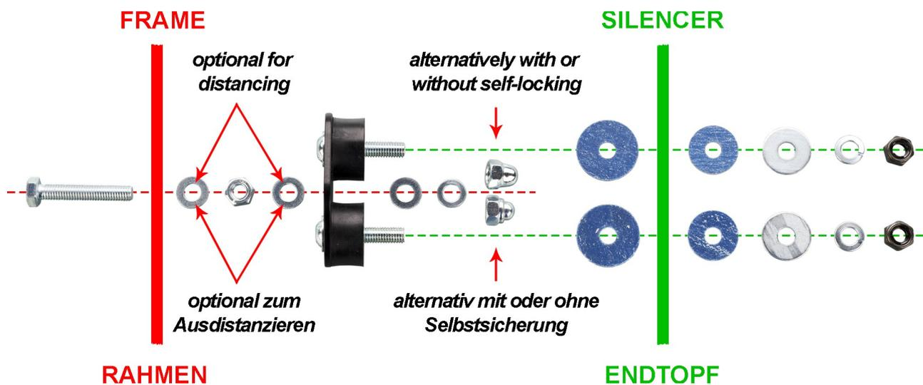
Gummidämpfer, Buchse und große U-Scheibe innen im Kotflügel sind nicht im Set enthalten.
