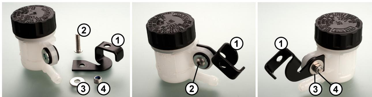
Alternativ kann der Behälter auch mit den originalen Befestigungselementen am Halter (1) verschraubt werden.
