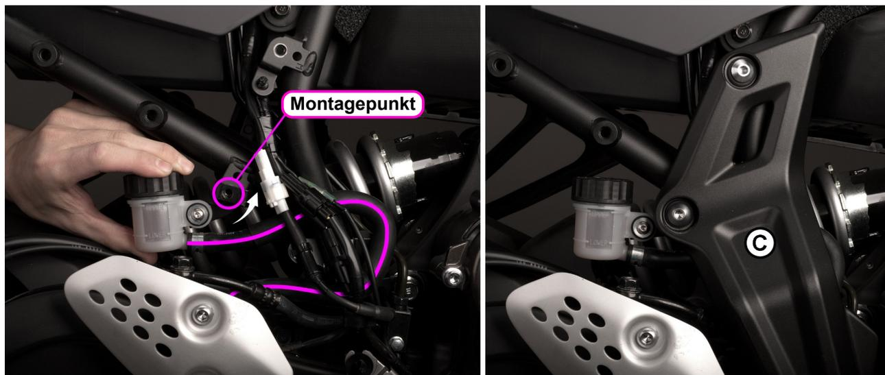
Den Ausgleichsbehälter-Halter von unten über die Rahmenhalterung schieben, so dass die Bohrung über dem Montagepunkt liegt.
