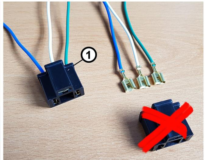
Die Kabelschuhe aus dem H4-Stecker lösen.
