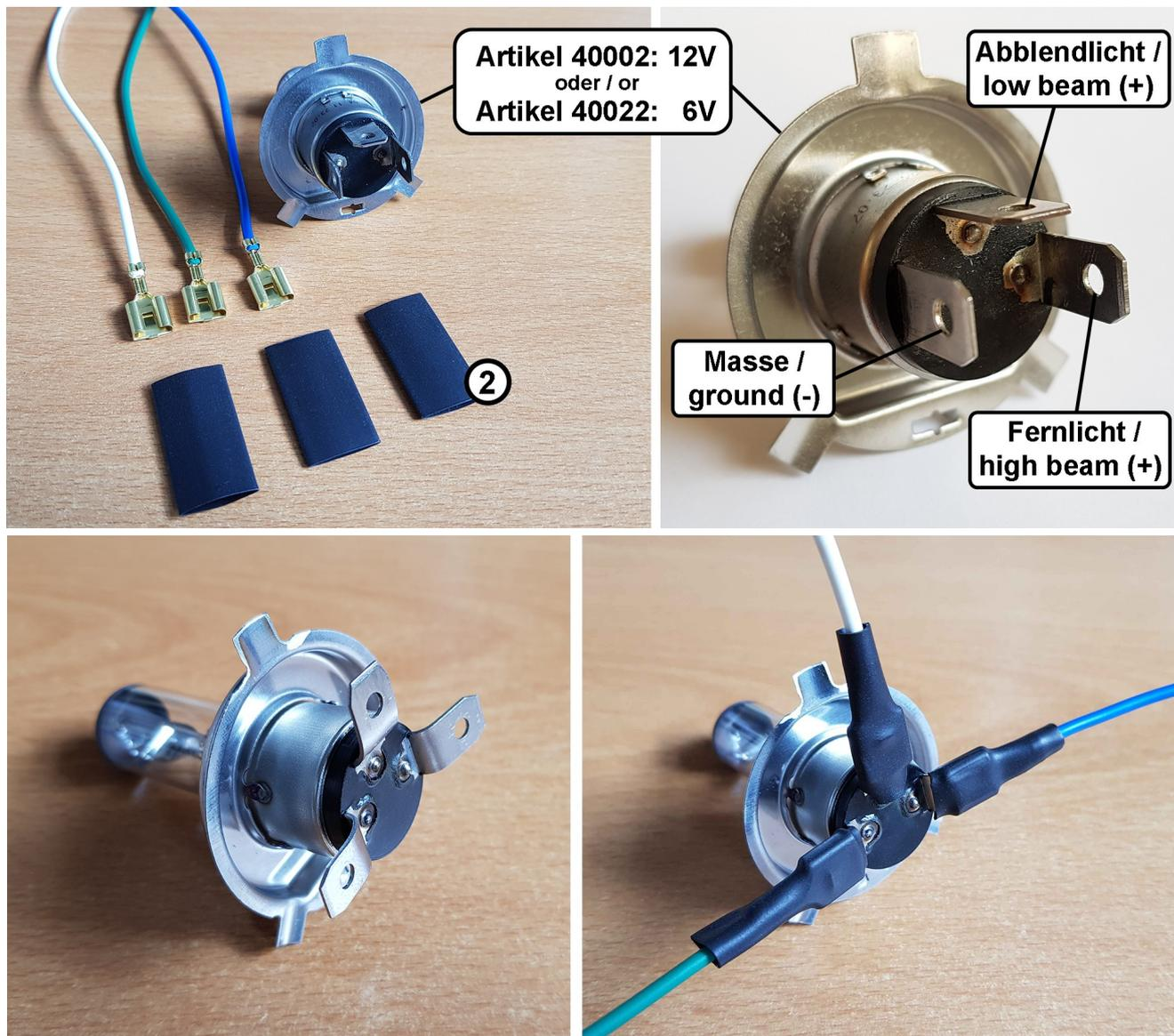
Die Anschlüsse des Leuchtmittels vorsichtig (nicht ganz unten am Ansatz) um 90° zur Seite biegen. Die vorbereiteten Kabel wie gezeigt anschließen und mit dem mitgelieferten Schrumpfschlauch **(2)** versehen.
