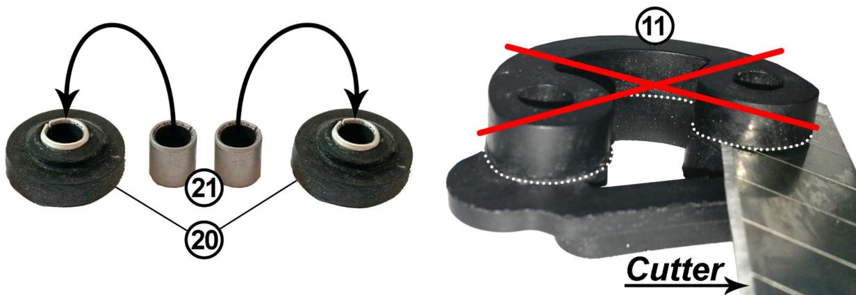
Die beiden Gummidämpfer (20) jeweils mit einer Dämpferbuchse (21) versehen.
