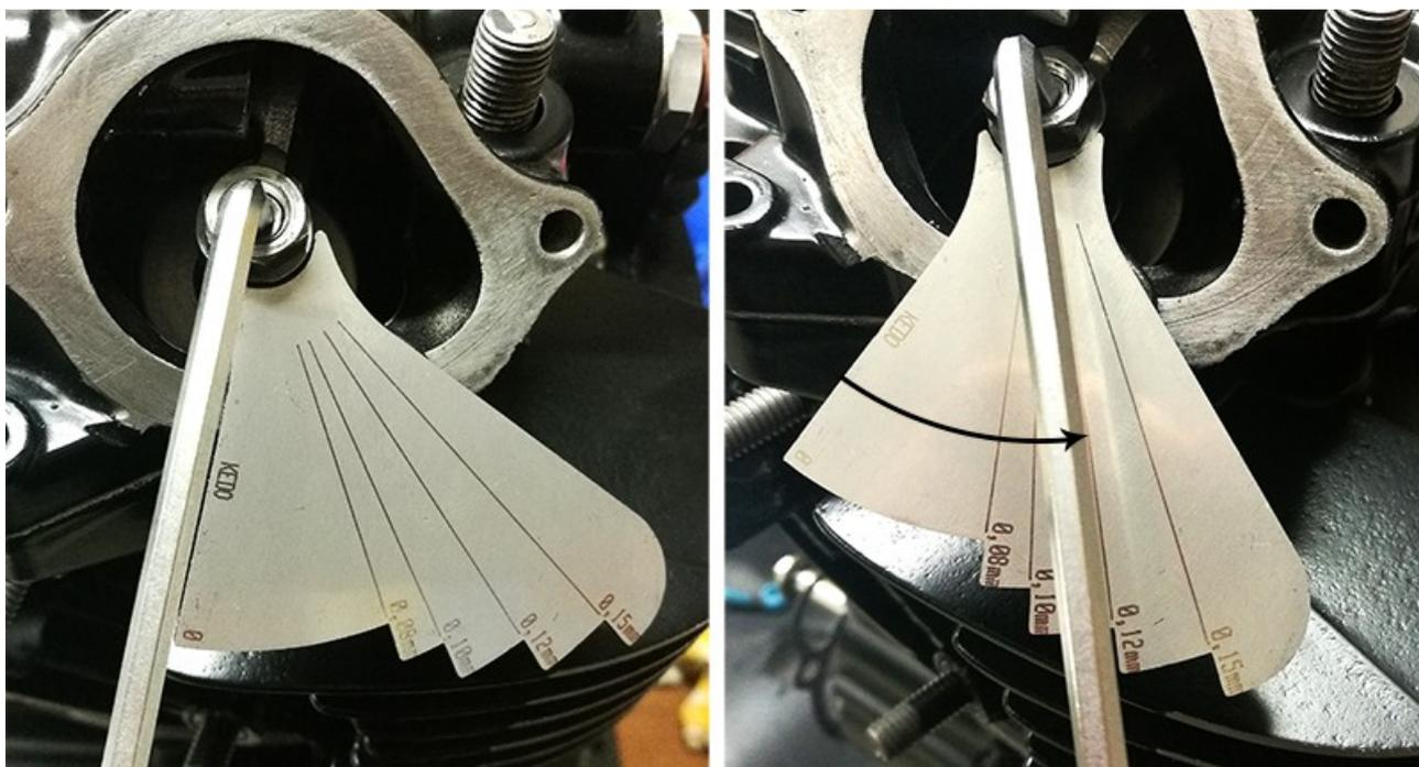
Anschließend den Innensechskantschlüssel in seiner Position halten und die Kontermutter wie gewohnt anziehen.
