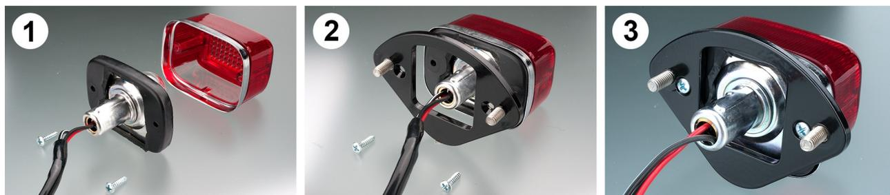
Anschließend kann die Adapterplatte mit dem Rücklicht an dem originalen XT500 Rücklichthalter montiert werden (hierfür die mitgelieferten, selbstsichernden Muttern und U-Scheiben verwenden).
