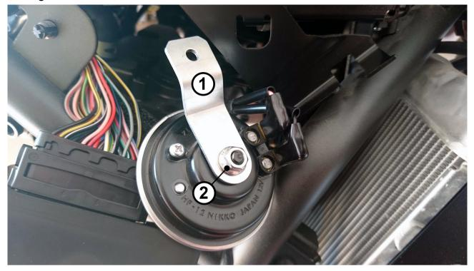
Original Hupenhalter durch den mitgelieferten Halter (1) ersetzen und mit der Sperrzahnmutter (2) befestigen.
