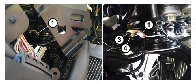
Den Hupenhalter (1) mit der U-Scheibe (3) und der Mutter (4) am M5 Gewinde unter dem ABS-Halteblech anschrauben.
