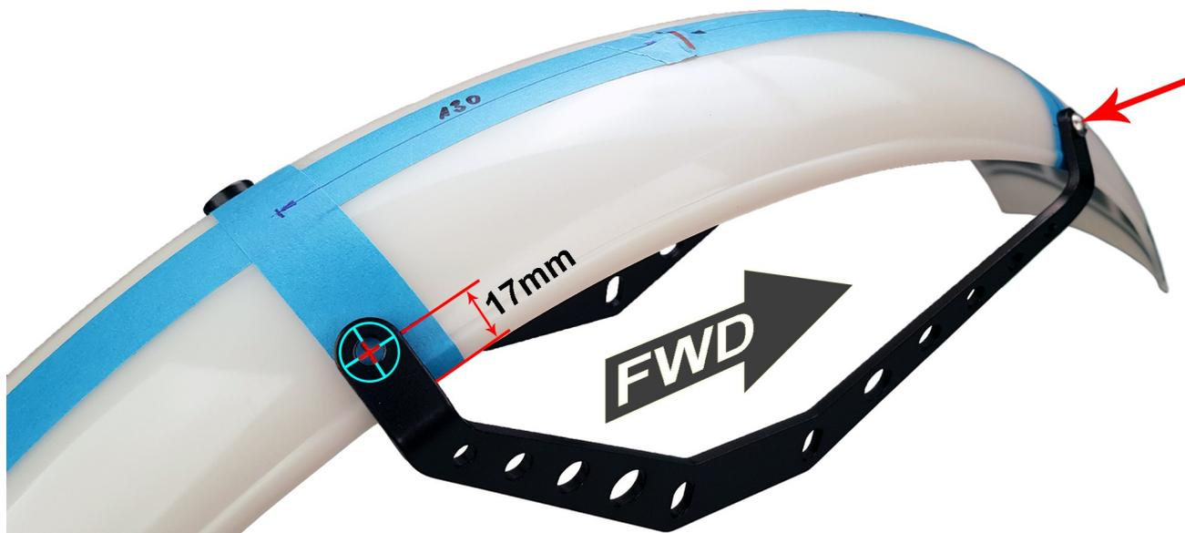
Die beiden Halter (1) und (2) mit dem vorderen, dem längeren „Schenkel“ an den ersten beiden Bohrungen temporär fixieren (Schraube (D) und Mutter (E)).
