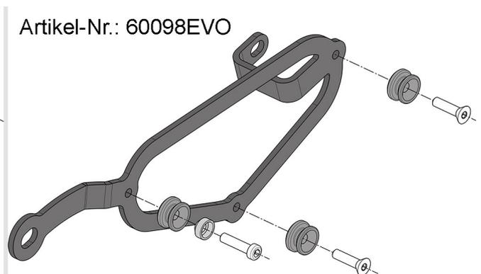
Für alle 3 Schrauben flüssige Schraubensicherung verwenden und mit **7 Nm** anziehen.
