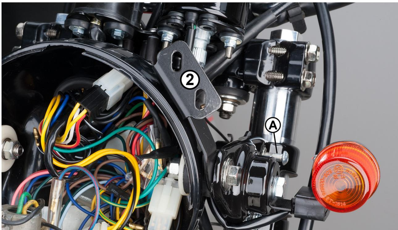
Die beiden Halter **(2)** und **(3)** zwischen die Lampenhalter und den Lampentopf legen, die seitlichen Befestigungsschrauben wieder einsetzen und leicht anziehen.
