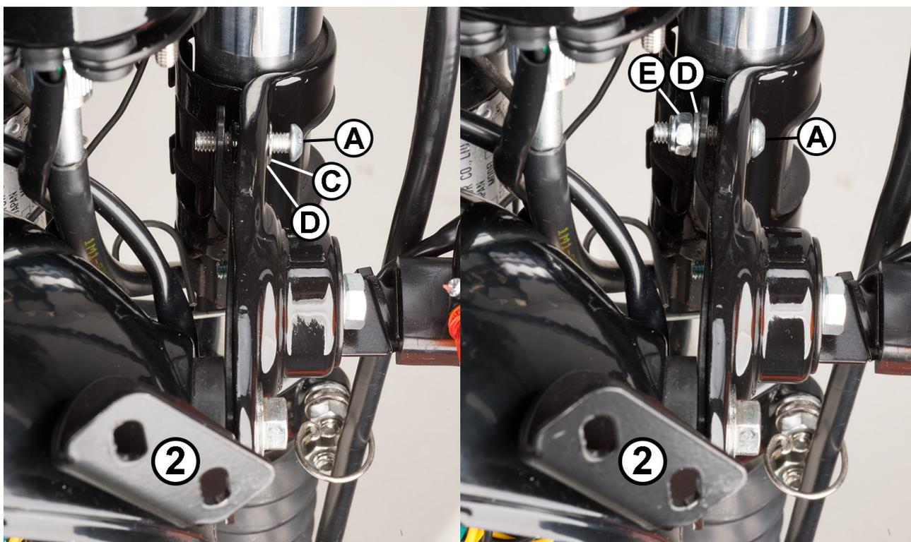
Die oberen Schrauben der Lampenhalter **(A)** soweit eindrehen, dass sie ein paar Millimeter durch die hinteren Langlöcher der Halter **(2)** und **(3)** reichen und die Muttern **(E)** und die U-Scheiben **(D)** von innen drauf schrauben.
