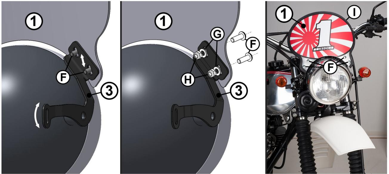
Die Tafel (1) mit den M5-Schrauben (F), den U-Scheiben (G) und den Muttern (H) auf die beiden Halter (2) und (3) montieren. Auch diese Schraubverbindungen noch nicht fest anziehen.
