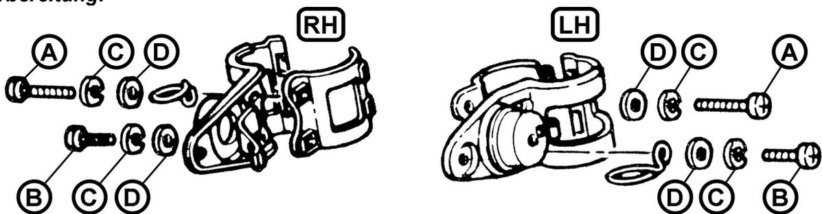
Die Originalschrauben der originalen Lampenhalter durch die mitgelieferten Schrauben **(A)** und **(B)** sowie die Scheiben **(C)** und **(D)** ersetzen.
