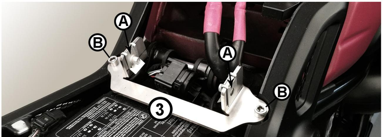
Die beiden Blechmuttern (A) auf den Sitzbankadapter (3) aufsetzen. Die genaue Position der Blechmuttern kann später angepasst werden. Den Sitzbankadapter (3) mit den beiden Schrauben (B) auf dem Rahmen montieren.
