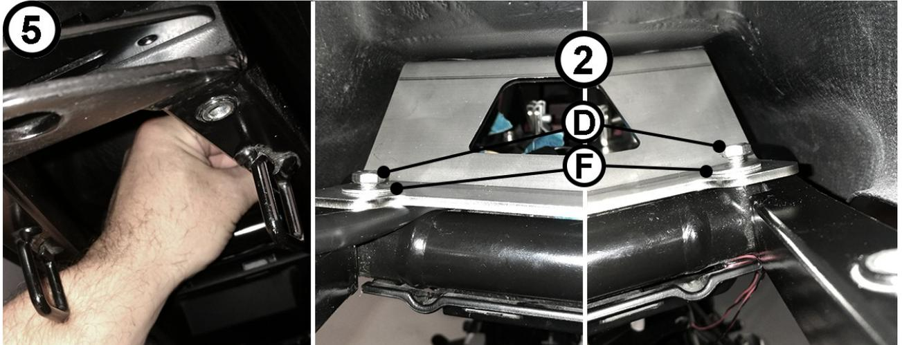
Die Bank (1) kann nun noch genau ausgerichtet werden, danach die vorderen und hinteren Befestigungen nochmals lösen und die Bank vorsichtig abnehmen. Das Montageblech (2) kann jetzt in der endgültigen Position mit der Sitzbank (1) verschraubt werden.
