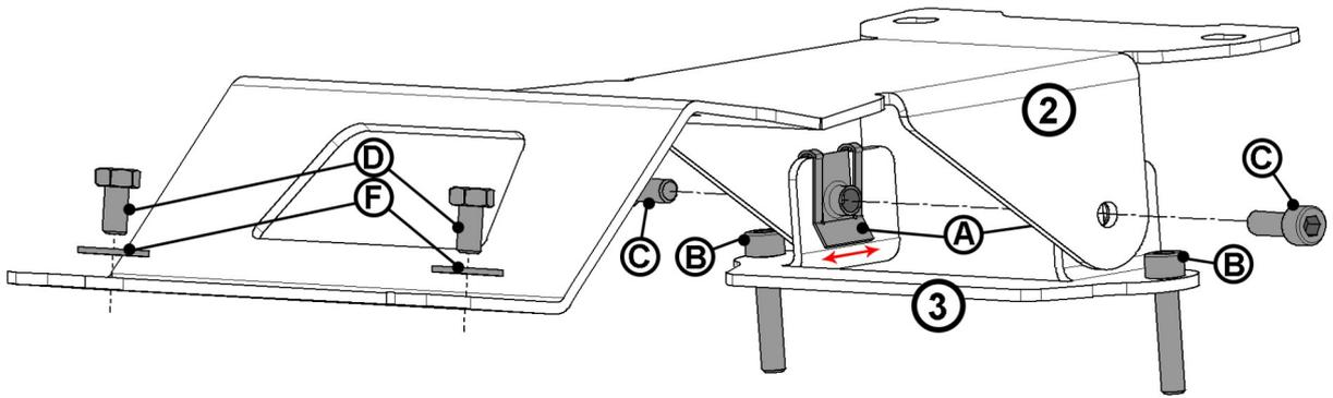
Anschließend die hinteren Befestigungspunkte des Montageblechs (2) mit den Schrauben (D) und den U-Scheiben (F) fixieren. *Hierzu muss von unten unter das Heck gegriffen werden.*
