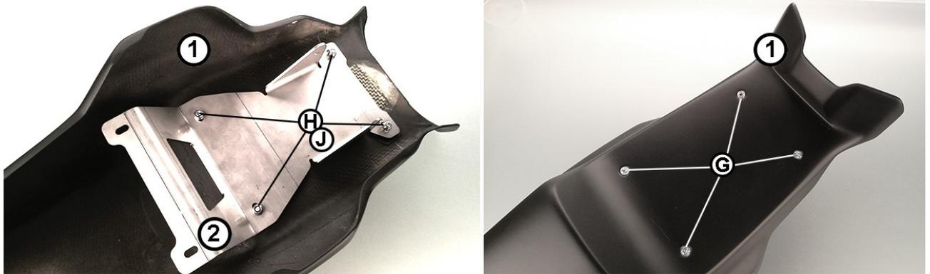
Das Montageblech (2) mit den Senkkopfschrauben (G), den U-Scheiben (H) und den Muttern (J) unter der Sitzbank (1) befestigt. Nur leicht anziehen, damit die eine spätere Ausrichtung bei der Montage möglich bleibt.
