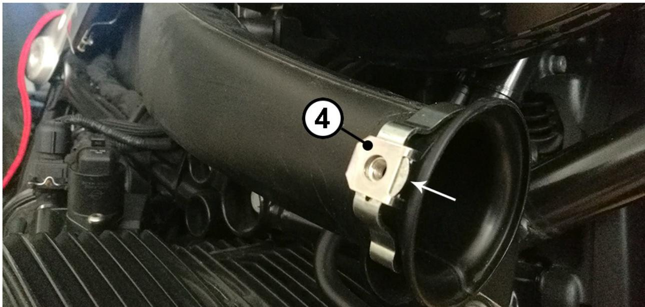
**[3]** JvB-moto Luftkanalabdeckung montieren.
