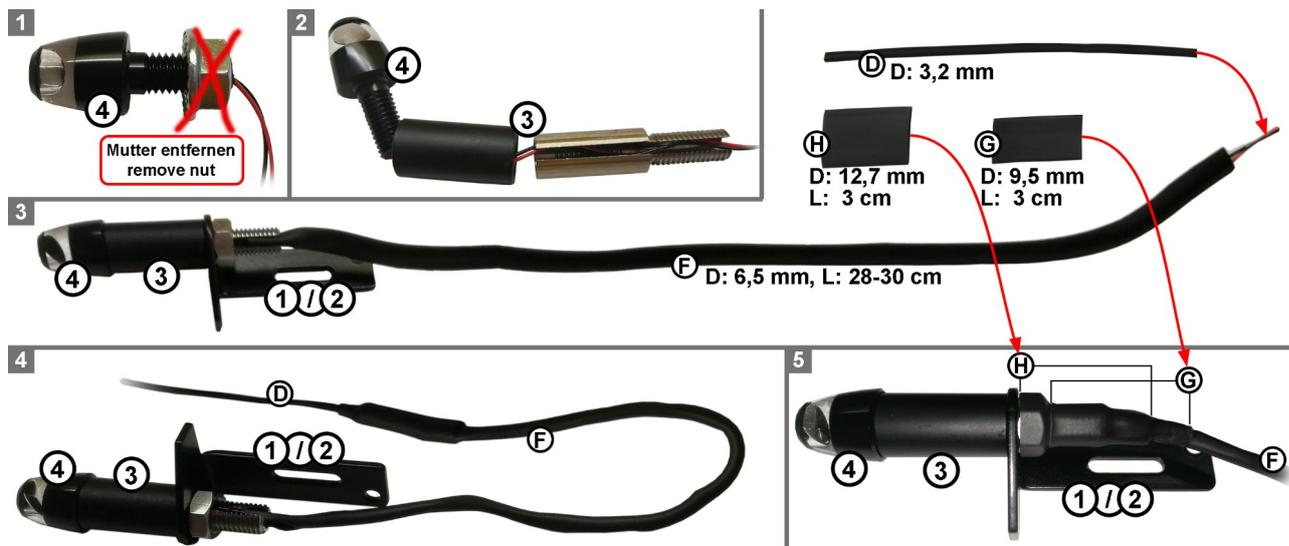
LED-Blinker (4) (ohne Flanschmutter) in die Blinkerverlängerung (3) einführen und verschrauben.
