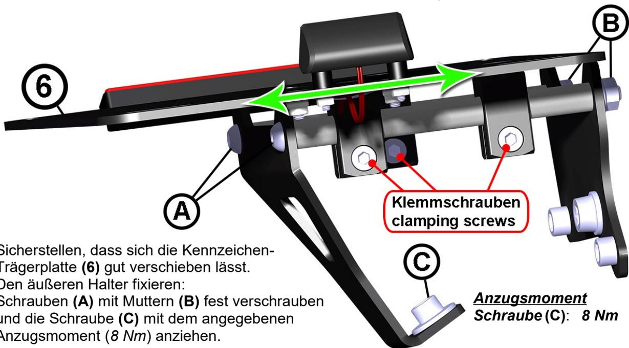
Sicherstellen, dass sich die Kennzeichen-Trägerplatte (6) gut verschieben lässt.
