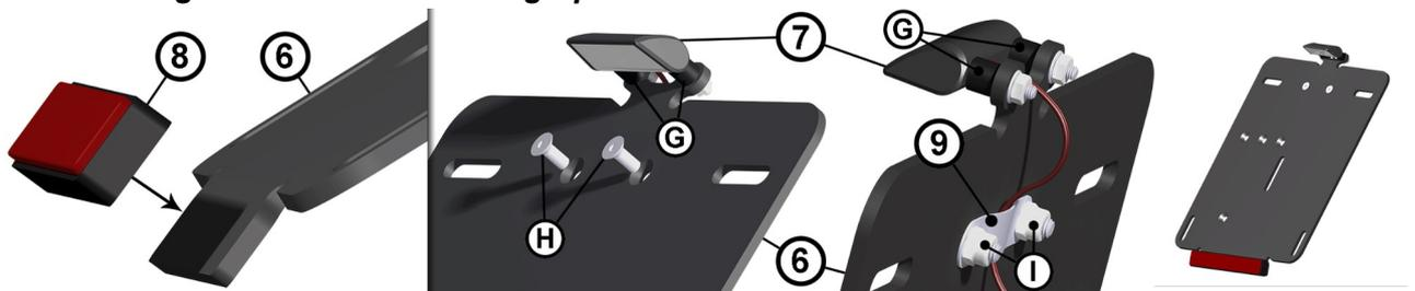
Den Reflektor (8) auf die abgewinkelte Fläche der Kennzeichen-Trägerplatte (6) aufkleben. Die Kennzeichenbeleuchtung (7) mit den Distanzbuchsen (G) versehen und oben an die Trägerplatte schrauben.
