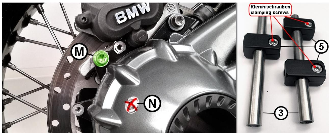
Die Bremssattel-Schraube (M) sowie die Abdeckschraube (N) entfernen.
