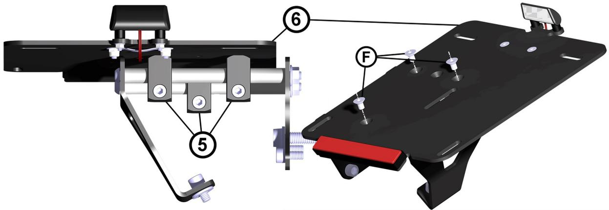
Die Klemhalter und die Platte anhand der Befestigungsbohrungen aufeinander ausrichten und die Platte mittels der Schrauben (F) auf den Klemmhaltern befestigen.
