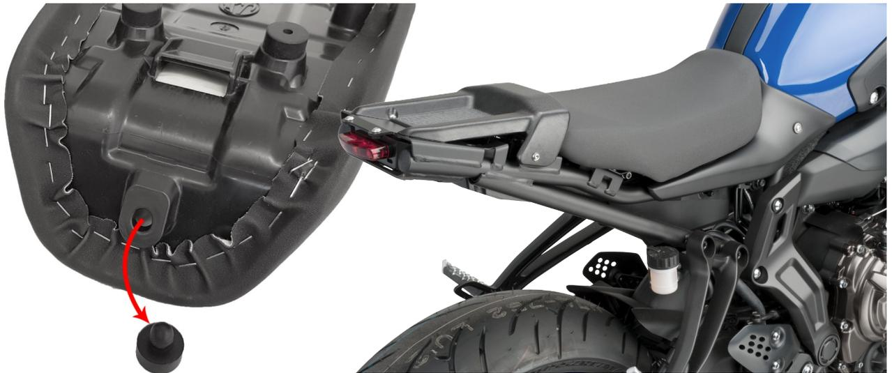
Den vorderen Gummi-Abstandshalter unter der Sitzbank (JVB0044) entfernen, bevor diese montiert wird.
