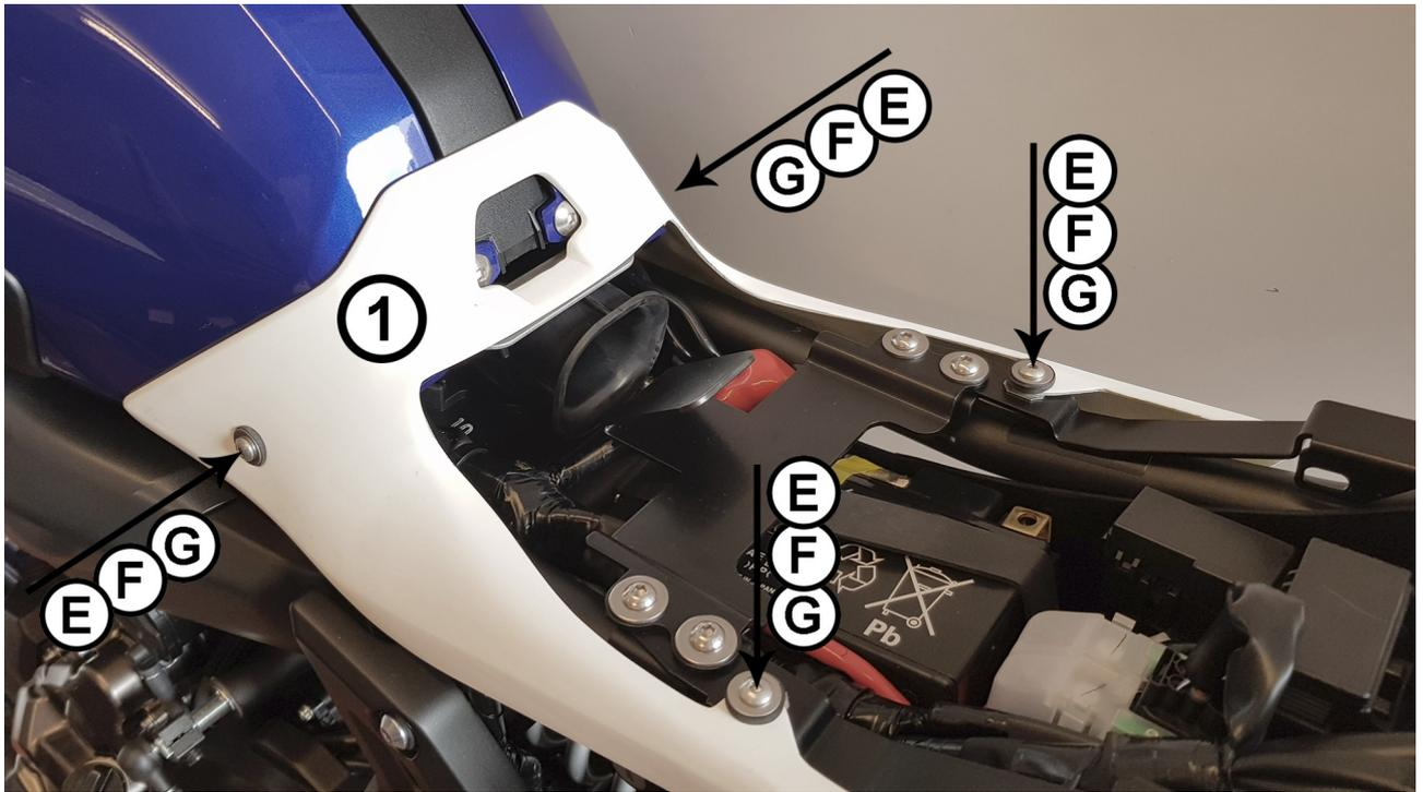
Die GFK-Verkleidung (1) vorsichtig anlegen und mit den Schrauben (E), den U-Scheiben (F) und den Gummi-U-Scheiben (G) an den Käfigmuttern (D) befestigen.
