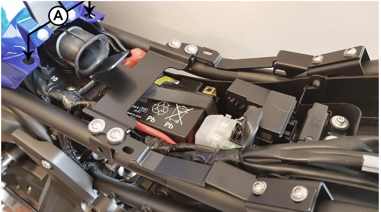
Zur Montage der GFK-Verkleidung (1) müssen die Sitzbankhalterungen aus Artikel-Nr. JVB0044 montiert werden.
