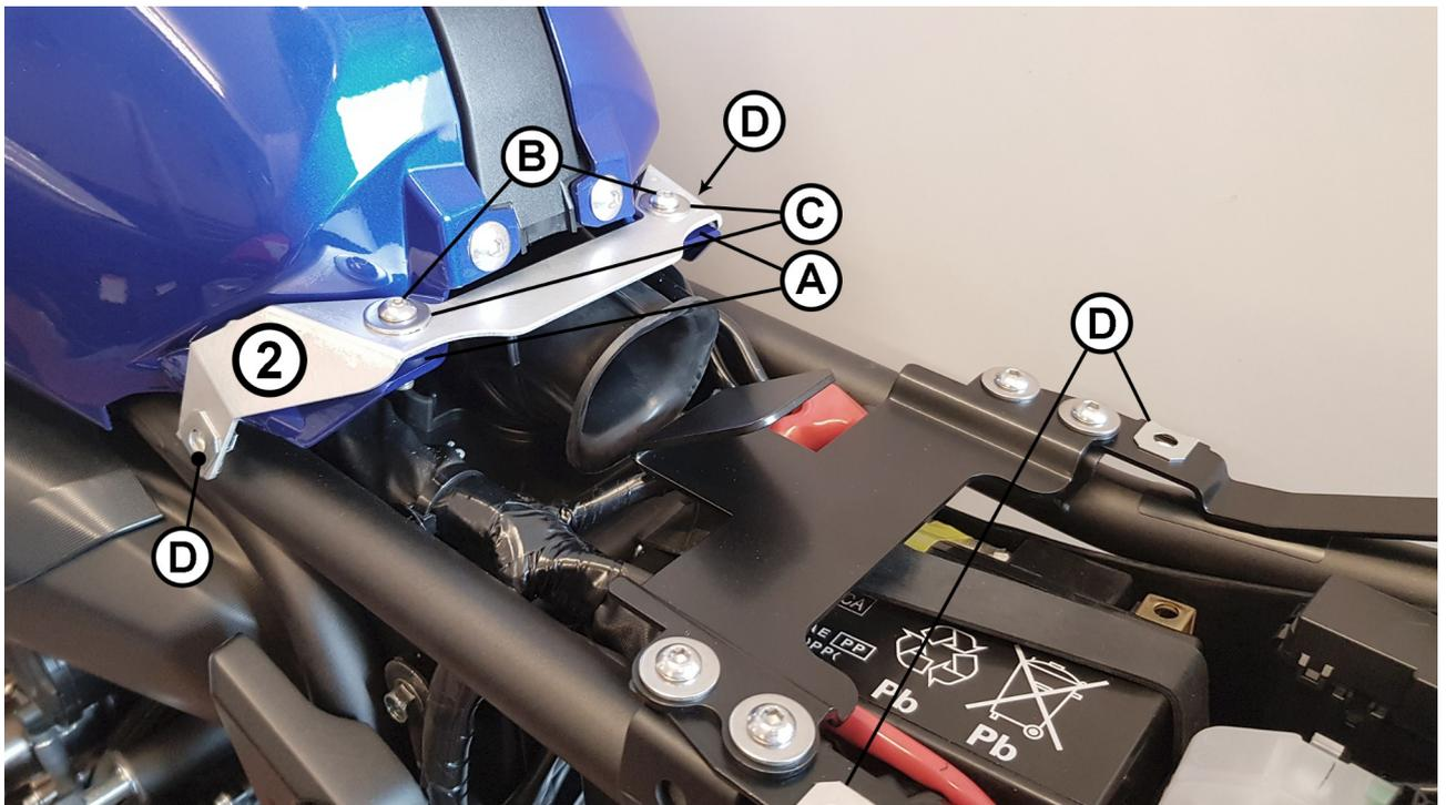
Das Montageblech (2) mit den Schrauben (B) und den U-Scheiben (C) mit den eingesetzten Gummidübeln (A) an der Tankverkleidung verschrauben.
