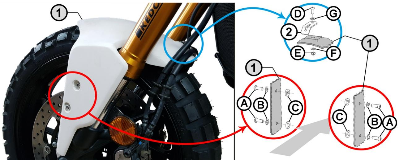
Montage an den Original-Haltepunkten des vorderen Kotflügels.
