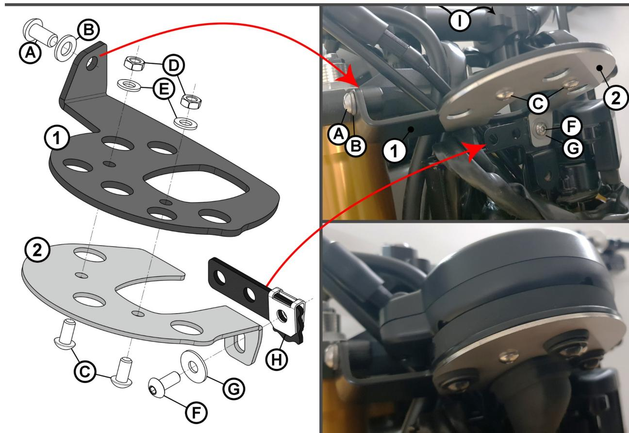
Die schwarzen Aluminiumschrauben (I) dienen der Abdeckung der OEM-Tachoaufnahme.
