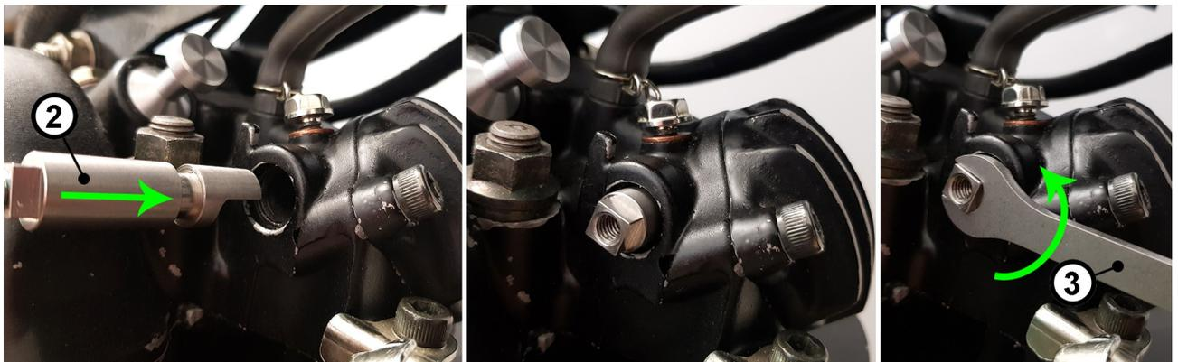
Die Dekohebel-Welle (2) mit der „offenen“ Seite nach unten so weit einstecken, dass sich die Welle nur noch um wenige Grad verdrehen lässt. Den mitgelieferten Maulschlüssel (3) auf den Vierkant aufsetzen und die Welle (2) entgegen dem Urzeigersinn bis zum Anschlag drehen. Die daraus resultierende Winkel-Position des Vierkants merken und für die weitere Montage beibehalten.
